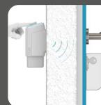
Der ekey uno erkennt Ihren Finger und sendet ein verschlüsseltes Signal zum Türschlossantrieb. Dieser dreht den Schlüssel und ent- bzw. versperrt die Haustür.
