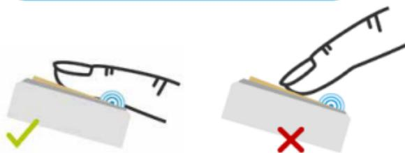
Ihr Gerät ist mit einem Aktivierungssensor ausgestattet, um die lange Akkulaufzeit von ca. 6 Monaten zu ermöglichen. Der Aktivierungssensor ist hier mit einem blauen Symbol abgebildet. Achten Sie bei der Bedienung des ekey uno stets darauf, auch den Aktivierungssensor zu berühren. Das Gerät bleibt sonst inaktiv.
