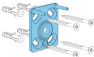
Bringen Sie die Montageplatte in der vorab gewählten Montageposition an. Sie können die Montageplatte aufkleben oder mittels der mitgelieferten Dübel und Schrauben befestigen.
