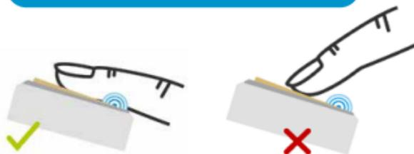
Ihr Gerät ist mit einem Aktivierungssensor ausgestattet, um die lange Akkulaufzeit von ca. 6 Monaten zu ermöglichen. Der Aktivierungssensor ist hier mit einem blauen Symbol abgebildet. Achten Sie bei der Bedienung des ekey uno stets darauf, auch den Aktivierungssensor zu berühren. Das Gerät bleibt sonst inaktiv.
