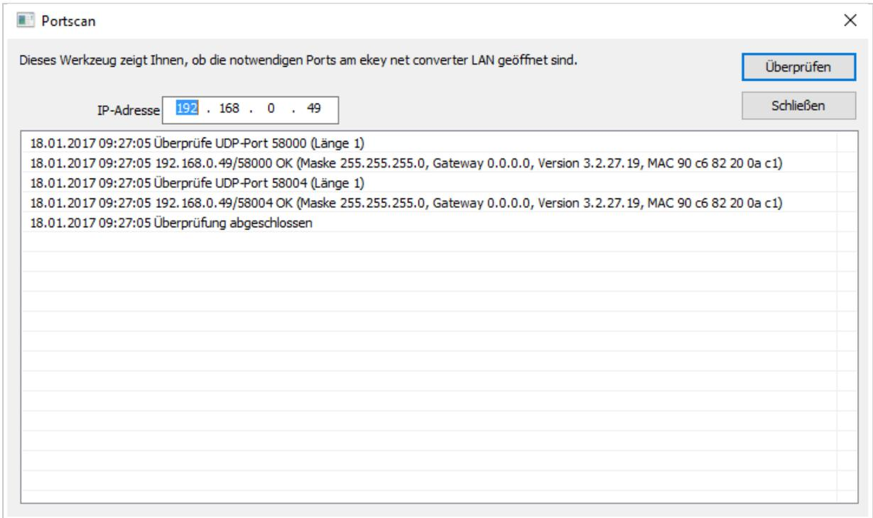
Abb. 21: **EKEY NET CONVERTER LAN KONFIGURIEREN: PORTSCAN**
