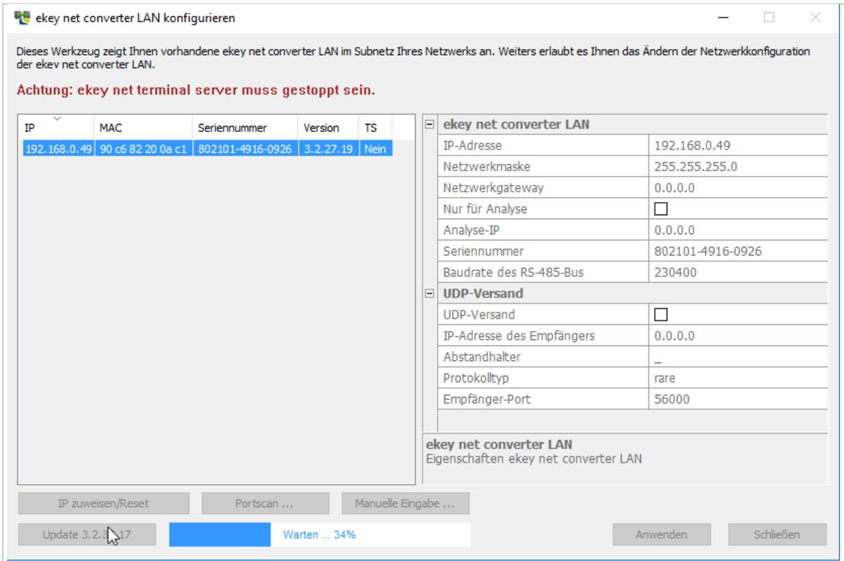
Abb. 24: **EKEY NET CONVERTER LAN KONFIGURIEREN: Firmwareaktualisierung**
