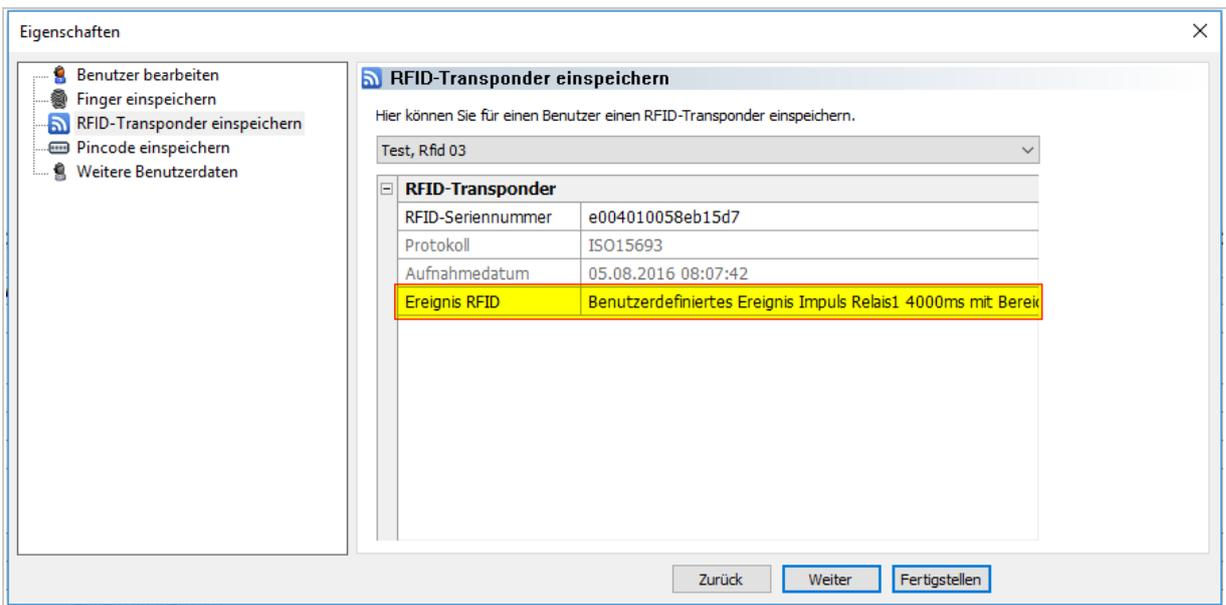
Abb. 160: Benutzerdefiniertes Ereignis an eine RFID-Seriennummer zuweisen
